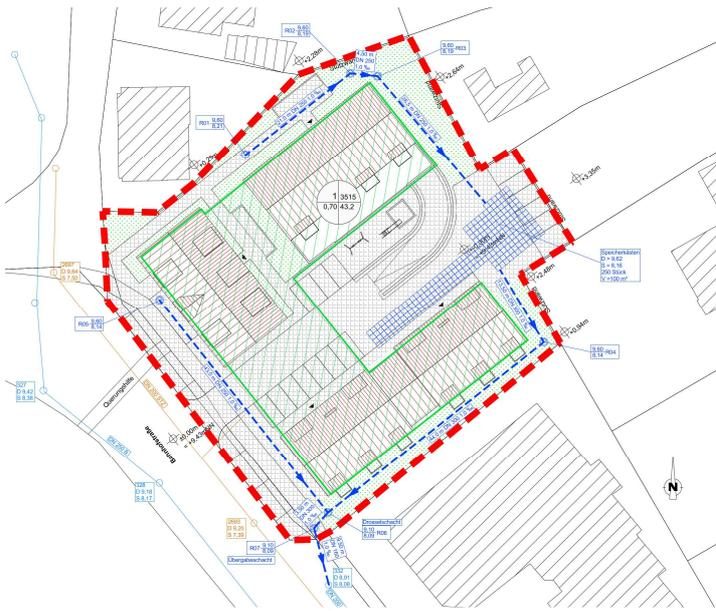
Abb. 5.: Auszug aus dem Oberflächenentwässerungskonzept
