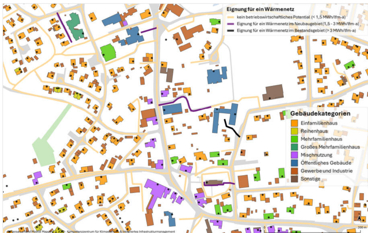
Abb. 11: Wärmelinieindichte ( \text{MWh/lfm}\cdot\text{a} ) und korrelierende geeignete Wärmenetztypen
