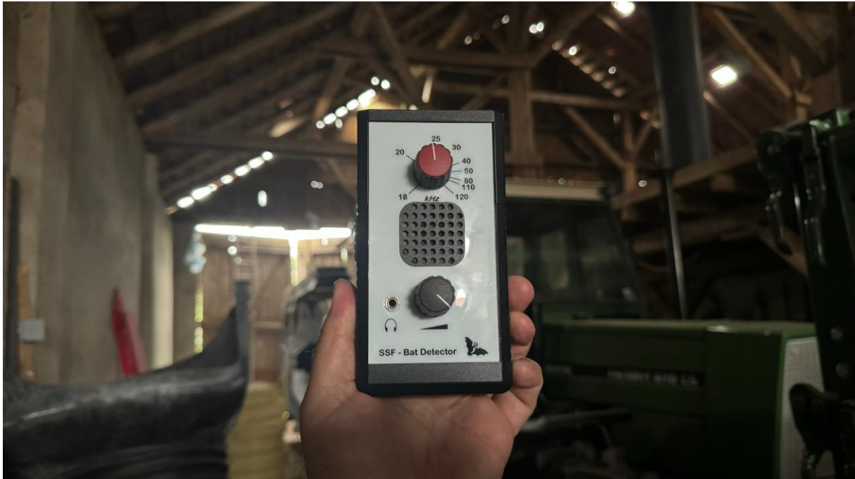
Abb. 10: Einsatz des Fledermaus-Detektors im ehemaligen Stall zur Erfassung möglicher Sozial- und Ortungslaute von Fledermäusen. Aufnahme: 03.05.2024
