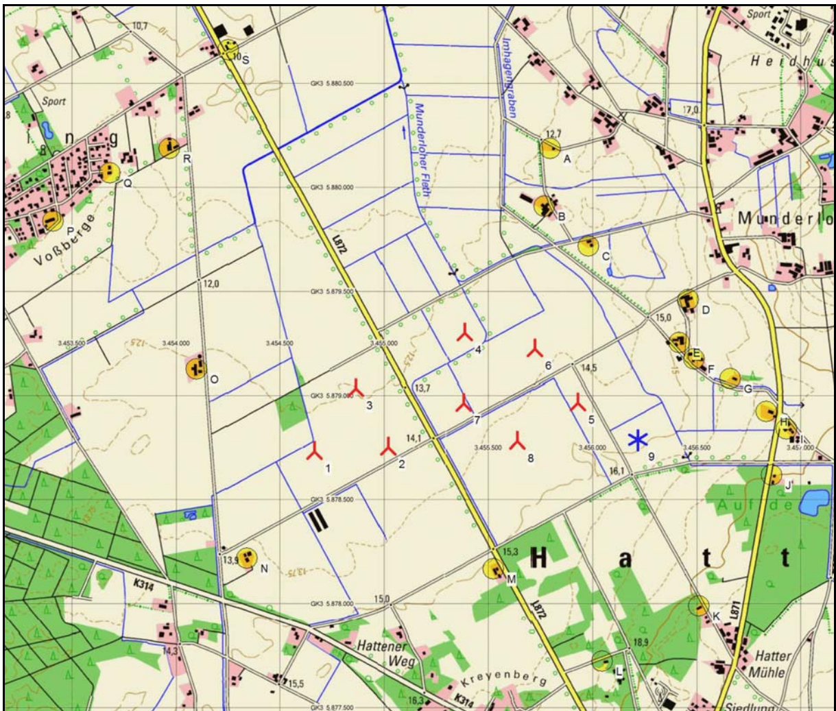
Abb.: Übersichtplan zu den geplanten Windenergieanlagen und den Immissionspunkten (siehe Gutachten, S. 18)
